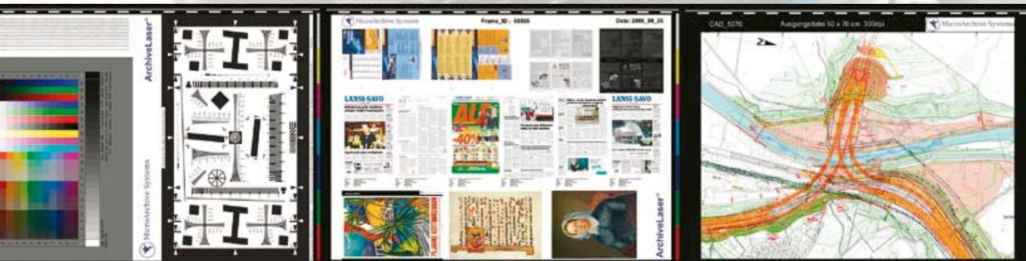
Die Abbildung unten zeigt einen vergrößerten 35 mm Frame, wie er vom ArchiveLaser® geschrieben wird. In diesem Beispiel wird der innovative Ansatz des Systems deutlich: mehrere Bilder und Metadaten auf einem Frame
